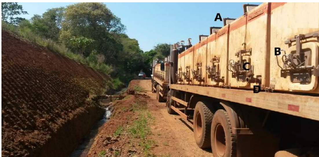
FIGURA 3.8 - Detalhes dos tanques de transporte de peixes vivos. (A) Tampa; (B) Escotilha; (C) Travas (D) Dreno
